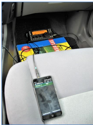
Die Kombi Smartphone (mit der App APRSdroid) & KX3, sowie die Magnetfußantenne im Einsatz
