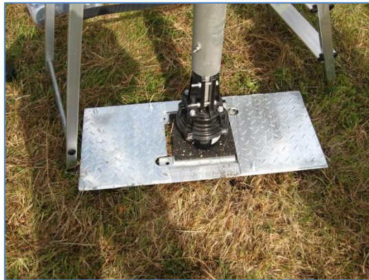
Der Rotor am Boden mit zusammengesetzter Bodenplatte und aufgesetzten Mast
