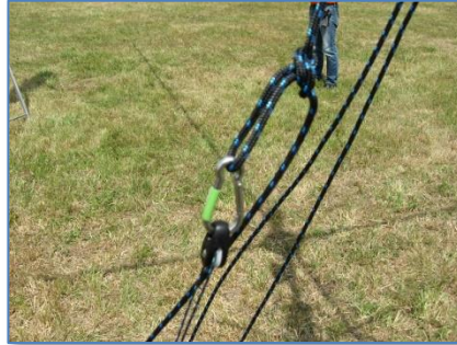
Der „Lift“ über Umlenkrolle an der obersten Abspannung befestigt
