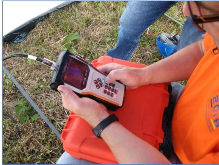
Stimmt auch das SWR? Elektrische Vermessung der Antennen
