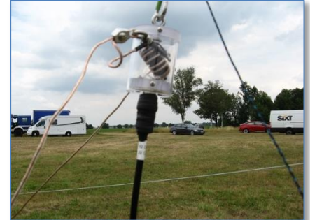
Das Balungehäuse, Koaxialkabel schon angeschlossen und am Lift eingehängt
