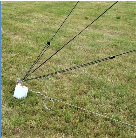
Am unteren Ende – Einer der drei Heringe mit vier Abspannungen
