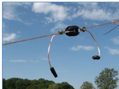
Für die Verlängerung des Dipols (Frequenzbereich für Telegraphie oder Telefonie)
