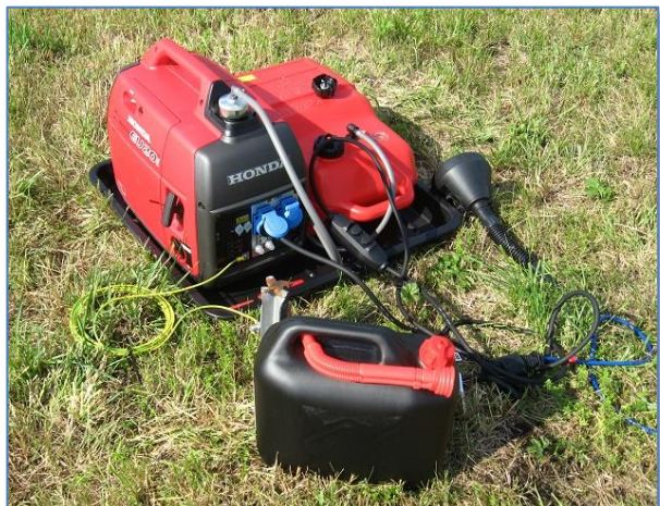
Das kleine Kraftwerk – auch mit Erdung
